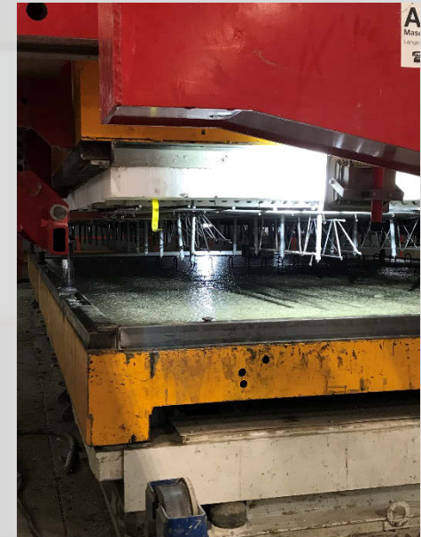
13. Einsenken der Erstschale in die Zweitschale
