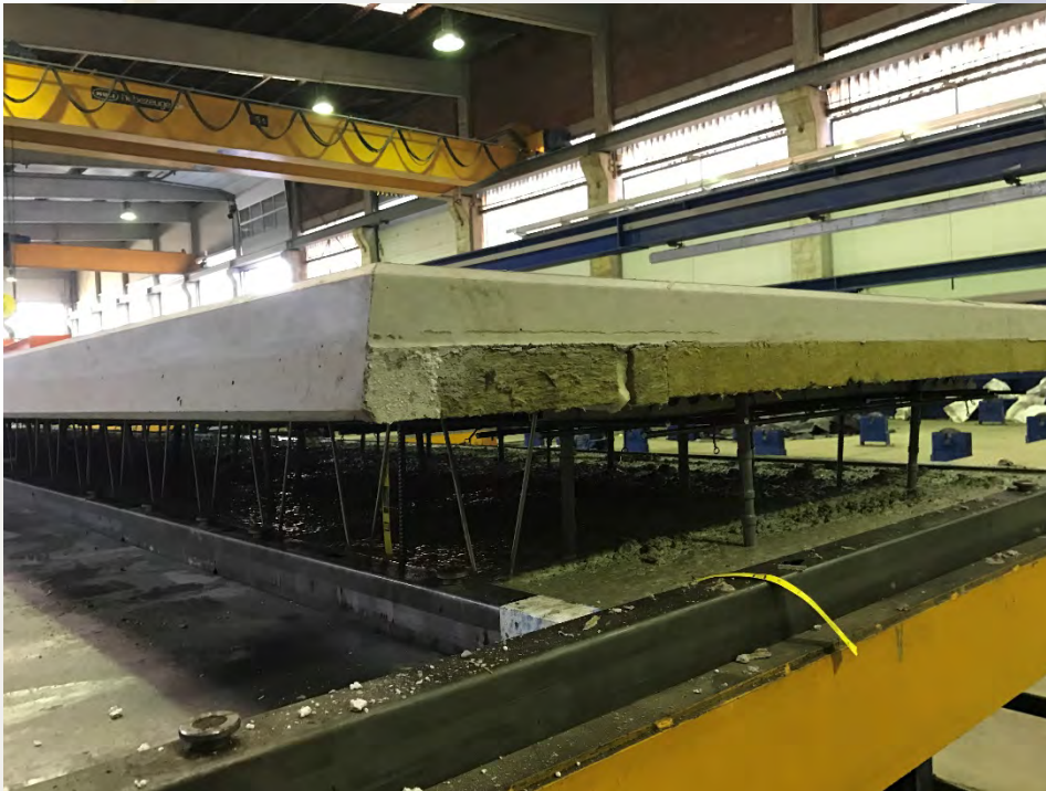
Thermowand mit Steinwoll-Dämmung
