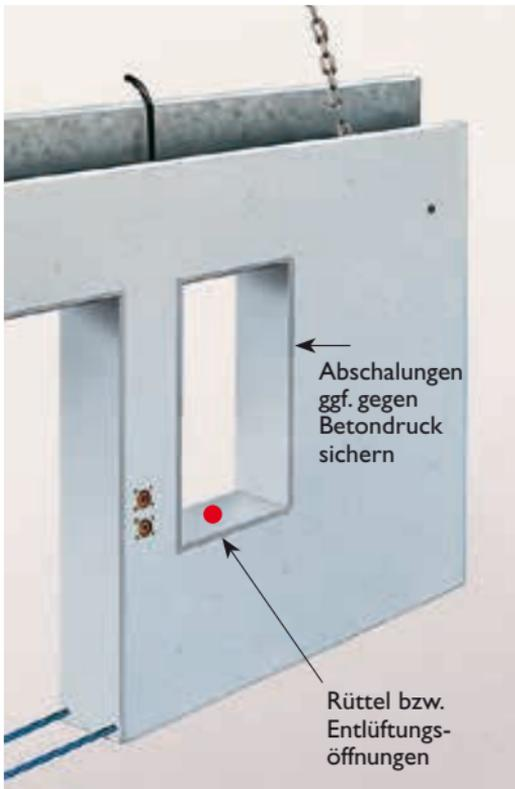
Abschalungen am Wandende oder an Aussparungen sind für den Betondruck in Wandrichtung zu sichern.
