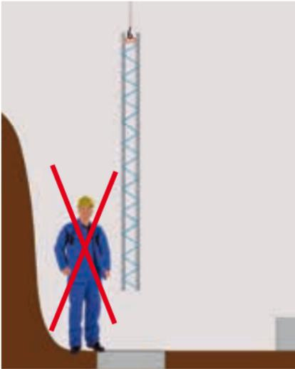
Bei Kranbetrieb und beim Absetzen des Elementes ist der Aufenthalt zwischen Wand und Böschung verboten.
