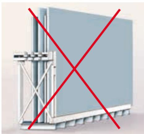
Elemente im Innenlader bei Zwischenlagerung (über mehrere Tage) sichern und gurten.
