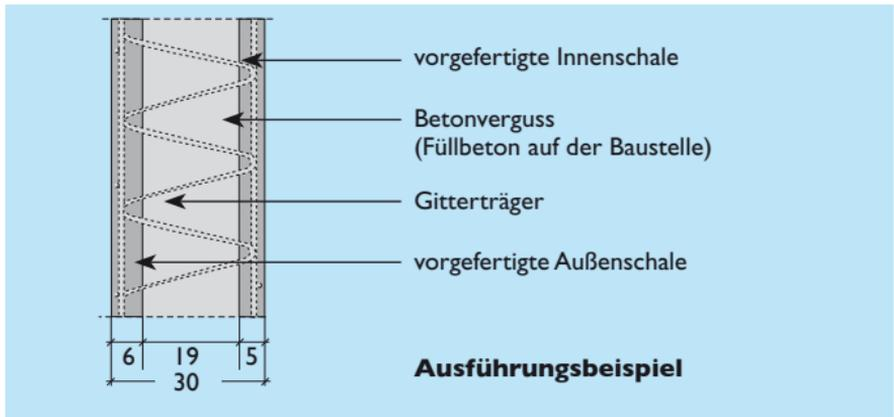
Die Fertigplatten (Schalen) sind in der Regel 5 cm bis 7 cm dick. Der Kernbeton muss mindestens 7 cm betragen, wobei im Ausnahmefall davon abgewichen werden kann. Für die Wandkonstruktion ist die bauaufsichtliche Zulassung (siehe Montageplan) zu beachten.
