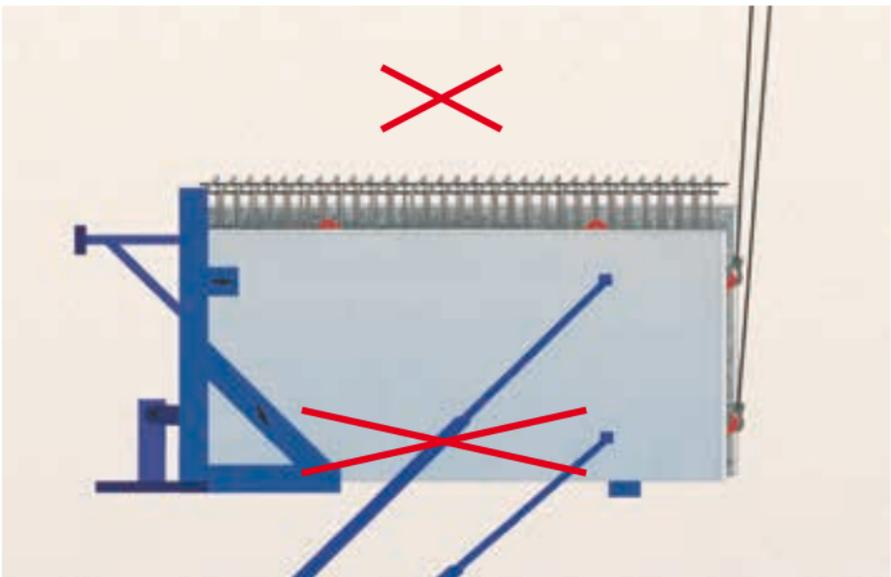
Sollen im Ausnahmefall Montagesprieße und Stoßbewehrungen bereits vor dem Anschlagen an den Wänden befestigt werden, sind besondere Sturzsicherungen gemäß UVV erforderlich.
