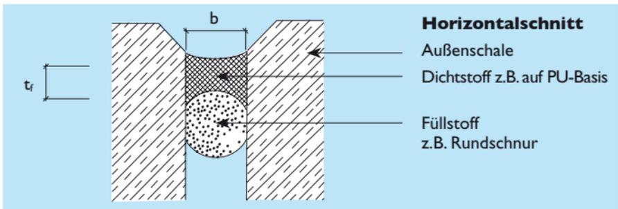
Die Fugen zwischen den Aussenschalen sind wie oben gezeigt elastisch nach DIN 18 540 zu schließen. Zu empfehlen sind hier „nicht wassersaugende“ Rundprofile z.B. geschlossenzellige PE Rundschnüre, die mit abgerundeten Werkzeugen vorsichtig in die Fuge eingebracht werden. Nach Einbringen des Füllstoffes werden die Betonflanken mit einem Primer eingestrichen. Der Dichtstoff wird so in die Fuge eingebracht, dass er bündig mit der Innenkante der Dreikantleiste abschließt.
