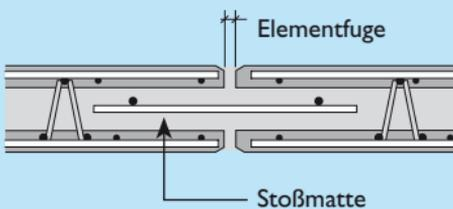
Die ggf. erforderliche Stoß- bzw. Anschlussbewehrung ist laut Statik einzubauen. In der Regel genügt ein Mattenstreifen als Stoßmatte.
