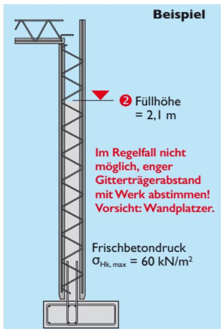
Reduzierung des Gitterträgerabstandes mit dem Werk abstimmen. Weitere Betonierlagen erst nach dem Ansteifen  $t_E$  (Zeitdauer vom Mischen bis Erstarrungsende nach DIN) der eingebrachten Lage einbauen.
