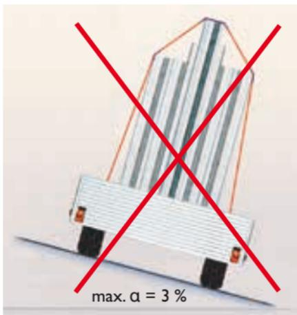
Waagerechte Standfläche mit maximaler Unebenheit von 20 cm auf 10 m Länge (Bodenfreiheit).
