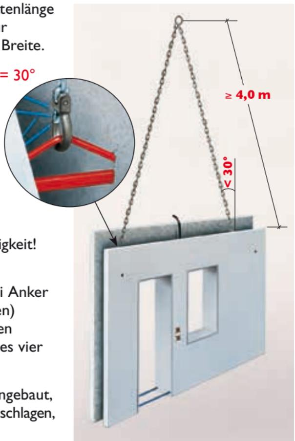
Die Transportanker bestehen aus einem Bügel mit Querbolzen, der etwa 25 cm unterhalb der Wandoberkante liegt. Querbolzen kann aus Rundstahl, Stahlrohr oder auch aus Holz bestehen.
