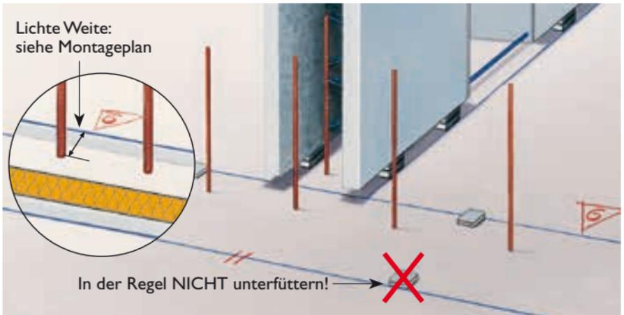
Besonderheiten entstehen beim Auftragen des Grundrisses. Die – in der Regel einreihige Anschlussbewehrung – liegt von der Innenschale um etwa 3 cm entfernt.
