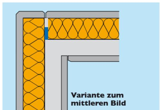
Grate, Schalungsversprünge, etc. an den Fasen sind bauseits vor dem Einbringen der Dichtstoffe nachzuarbeiten.
