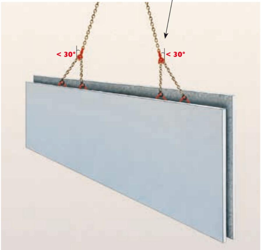
Der Einsatz von nur **2 Spezialabhebern** (schwere Wände) mit hohen Tragfähigkeiten jeweils über 5 Tonnen ist mit dem Fertigteilwerk abzustimmen.
