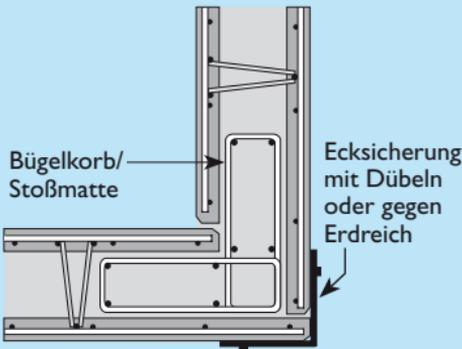
Am Eck und T-Stoß sind Maßnahmen zur Sicherung des Betondruckes vorzusehen, wie z.B. Stahlwinkel, Absprießen gegen das Erdreich oder Aufdübeln einer Schiene.
